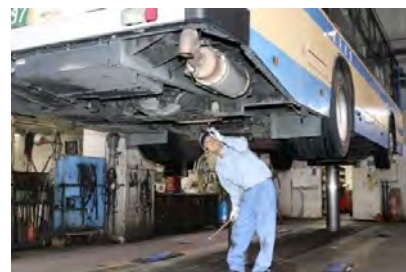
バス車両整備工場の整備用リフト
