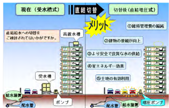
直結給水への切り替え (イメージ)
