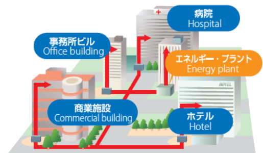
地域冷暖房 (イメージ図) Schematic of District Heating & Cooling System
