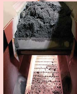
振動スクリーン内部 Interior of vibrating screen
