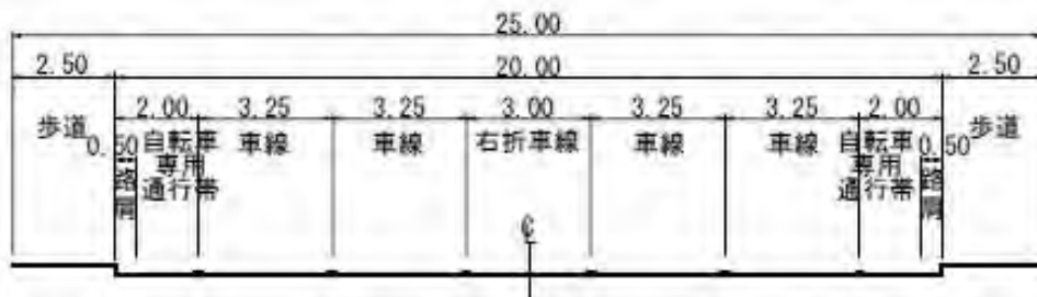
図 2.2-2(3) 環状 4 号線 (北区間) の標準断面図
