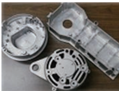
弊社金型によるダイカスト製品 (金型は知財関係上紹介省略)
