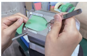
熟練技能者マスクング(誤差精度0.5mm)
