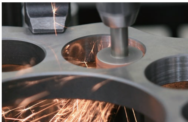
ジグ研削加工の様子、内径研磨
