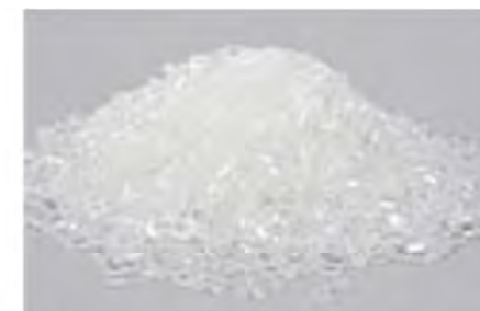
再生ペットボトルの原料となる使用済ペットボトルの加工品 (ペレット)
