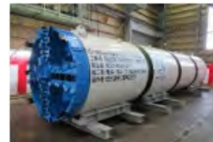
シールドマシン (中和田雨水幹線)
