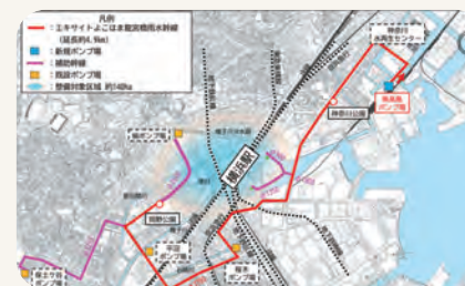
エキサイトよこはま龍宮橋雨水幹線概要図
