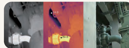
AIによる異常発熱検知実験
