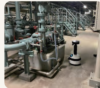
AGVでの自動巡回点検実験の様子
