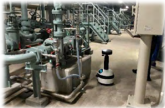
AGVでの自動巡回点検実験の様子
