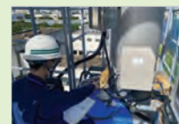
事業所への立入検査 (排出ガス測定)
