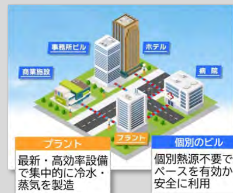
地域冷暖房の仕組み
