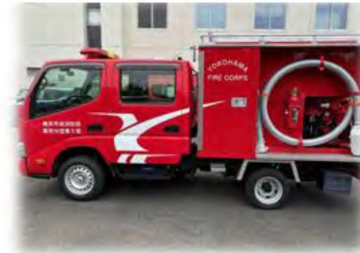
《参考図》 可搬式小型動力ポンプ積載用自動車普通自動車:トラックタイプ)
