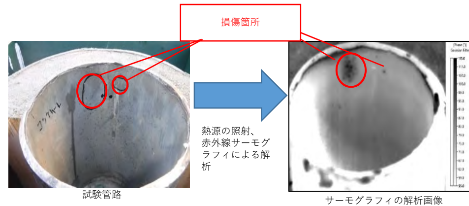
赤外線サーモグラフィによる損傷箇所の特定の様子（共同研究）
