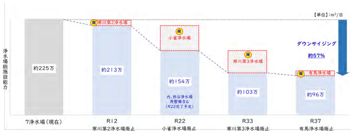
【図-6：廃止年度毎の水道事業者の浄水場総施設能力】
