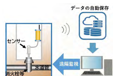
遠隔での漏水監視イメージ
