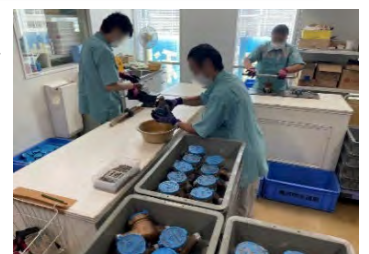
水道メーター分解作業
