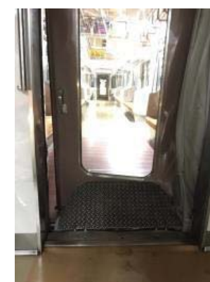
貫通扉、連結ホコの損傷
