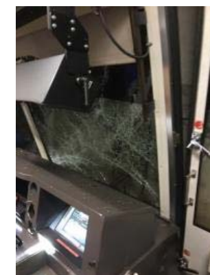
車体前面の窓ガラスが破損
