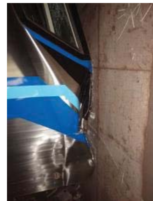
先頭車両が前方の壁に衝突
