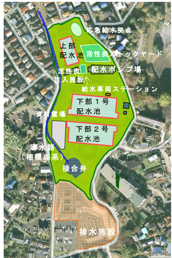
図6 鶴ヶ峰配水池平面図(再整備後)
