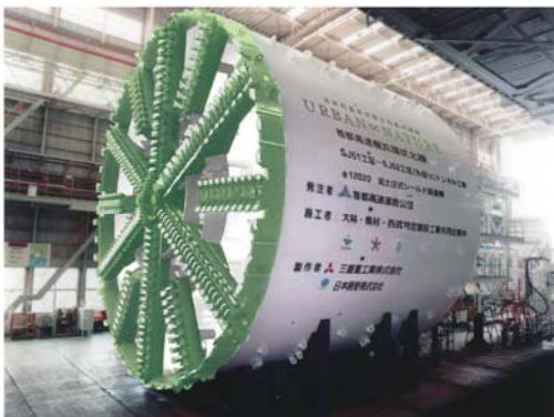
① シールドマシン完成イメージ (直径：約 12.5m)
