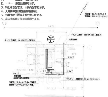
1階平面詳細図 (改修後) (S=I/50)
