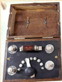
電波そのもののエネルギーで音を鳴らす『鉱石ラジオ』
