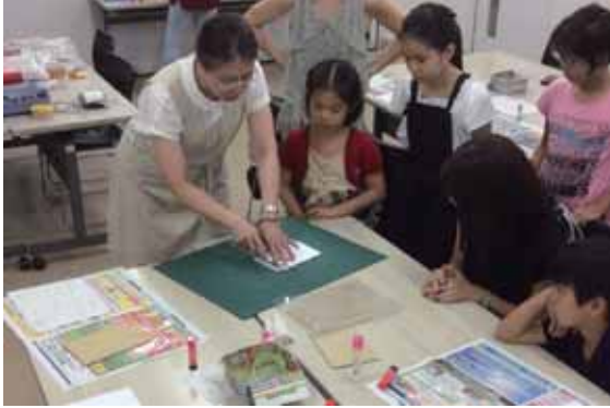
▲化粧裁ちをします。このひと手間でもとてもきれいに仕上がります。定規は力を入れてしっかり押さえ、カッターナイフには力を入れず、同じところを何度も繰り返し切ります。
