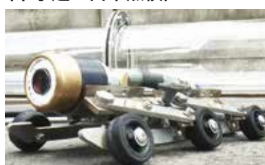
▲下水道管のそうじ・調査を行うノズルカメラ ▲カメラでみた下水道管の中
