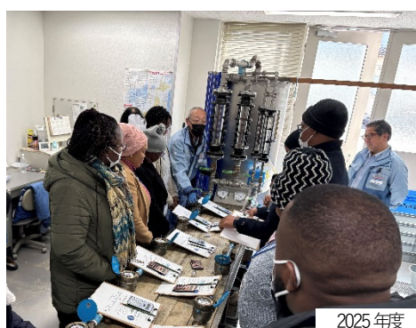
2025 年度 南アフリカ国来日研修の様子 （水道メーター器差試験）
