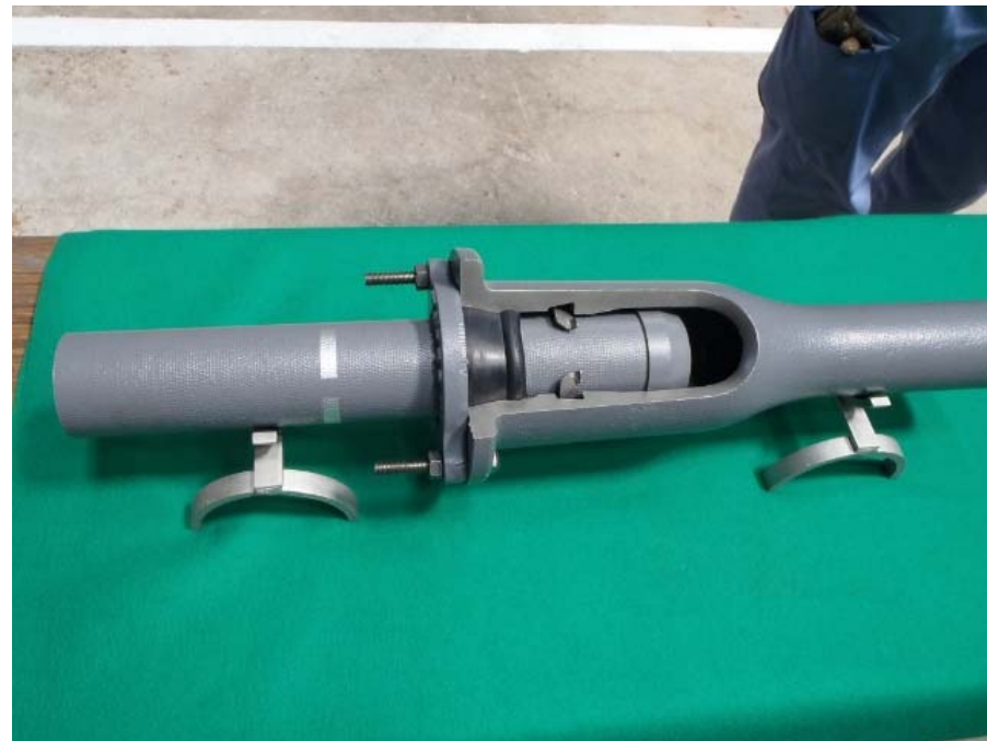
小口径耐震管の採用 （50mmダクタイル鋳鉄管）
