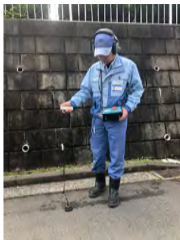
漏水調査の様子
