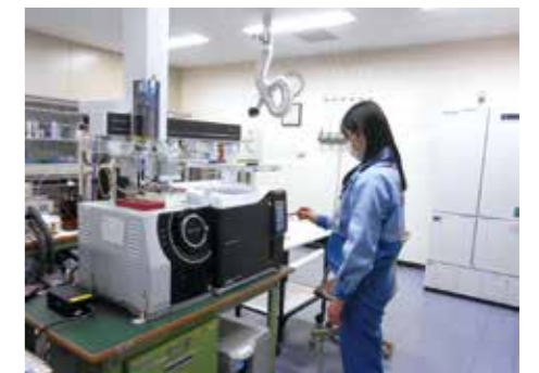
GC-MSによる有機物検査の様子
