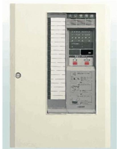
システム全体に電源を供給する役割も担っており、平常時はAC100V商用電源で動作するが、停電に備えて一定時間火災の発生を警戒できるように予備電源（蓄電池）を内蔵しています。予備電源には寿命があり、5年前後に1度交換が電池メーカーにより推奨されています。
