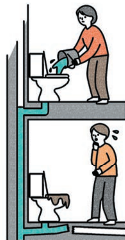
バケツ洗浄により 下層階で汚水があふれた様子
