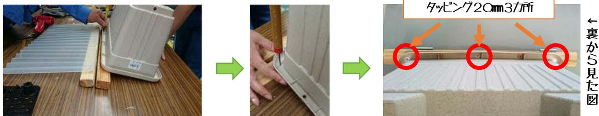
①左右コーナー2カ所、中央付近1カ所にキリなどで穴を開け②軽くトンカチで押し込む③ドライバーで締める
