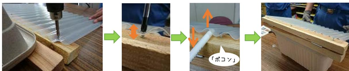
①角材より10mm上がった位置でネジをコーナー2カ所、中央1カ所を止める②波板をネジ皿に沿わせ、完成！
