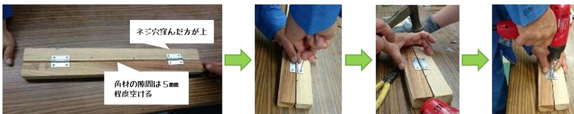
①大体の位置を合わせる②キリなどで穴を開け③軽くトンカチで押し込む(ネジが小さいから)④ドライバーで締める
