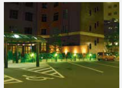
〈日本大通〉 フットライトを中心とした駐車場の照明の例
