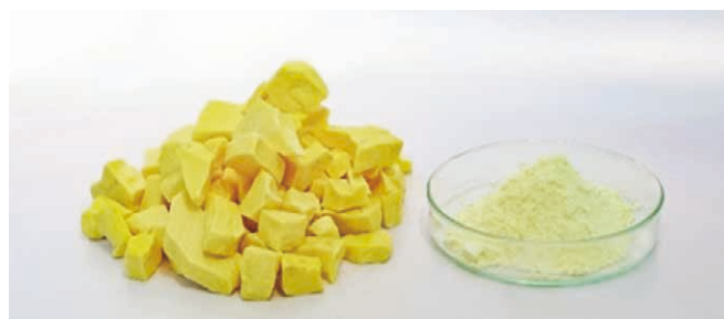
新たな生産技術で作成したアルジロナイト型硫化物固体電解質
