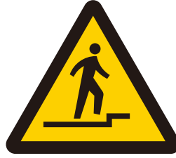
上り段差注意 Caution, uneven access / up
