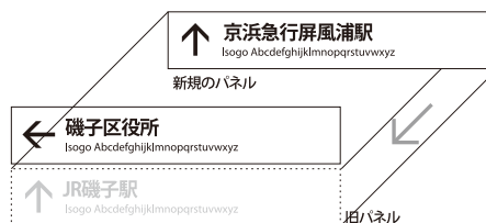
(長期メンテナンス) 既存パネルの取り外しと新規パネルの取り付け
