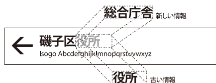
(短期メンテナンス) 修正用シートの貼り込み
