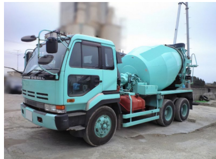
⑨ コンクリートミキサー車
