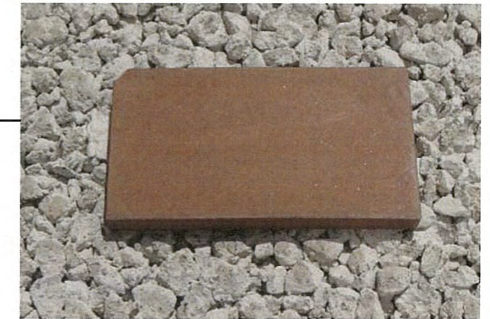
万国橋ビル復元部 既存タイル
