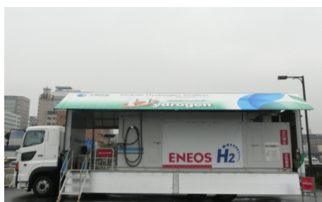
移動式水素ステーション
