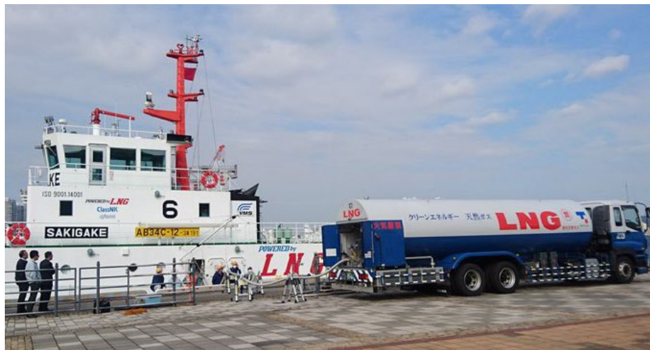
新港ふ頭 5号岸壁におけるTruck to Ship方式のLNG燃料供給の様子
