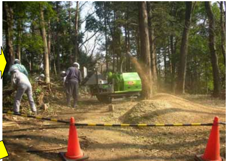
【写真 1 - 2】間伐材資源循環事業 機械によるチップ化作業支援の状況
