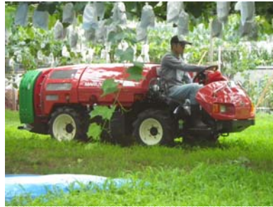
【写真】効率的な農薬散布が行えるスピードスプレーヤー
