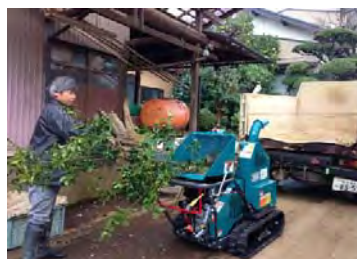
【写真】チップーシュレッダー 剪定枝を粉碎して堆肥にします。
