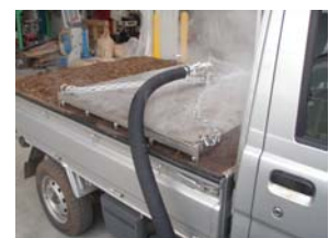
【写真】 蒸気式土壌消毒機
