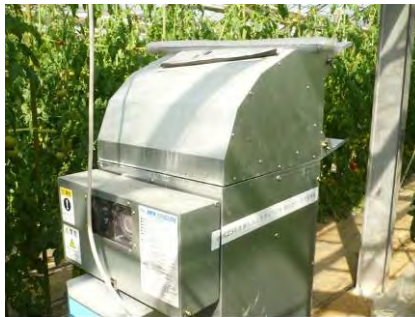
【写真】ハウス内に設置した炭酸ガス発生装置
