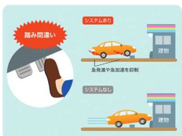
ペダル踏み間違い急発進抑制装置
