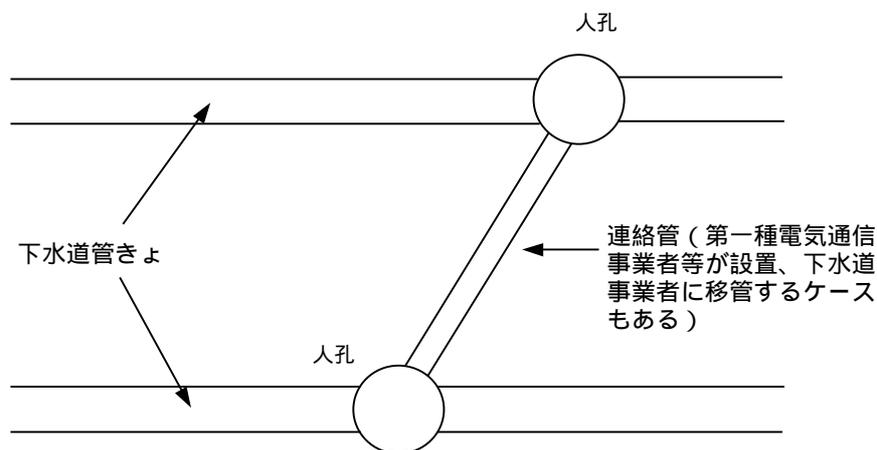
図1.2.2 人孔と人孔を接続する連絡管
