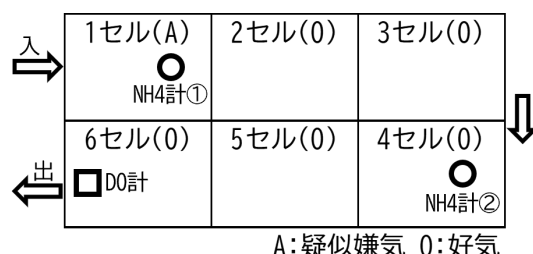
図－1 1系反応タンク平面図
