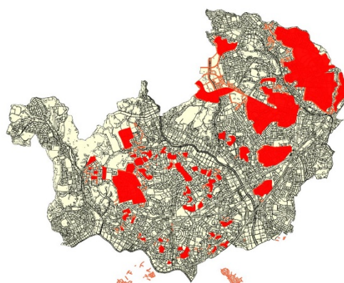
図-1 青葉区における Z パイプ分布状況
