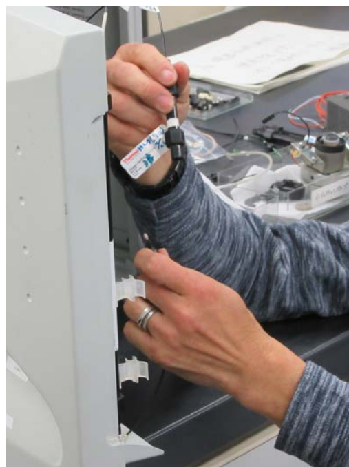
写真-1 イオンクロマトグラフのカラムを交換する様子
