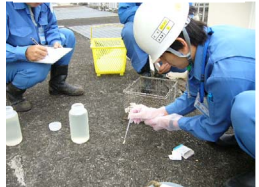
写真-2 場内点検 (pH測定)
