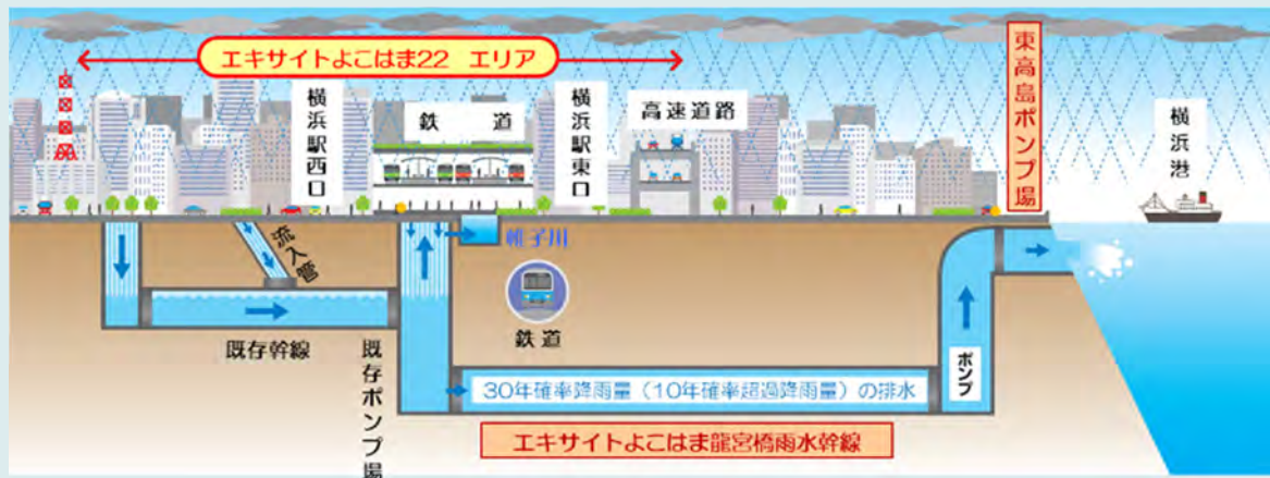
エキサイトよこはま龍宮橋雨水幹線と東高島ポンプ場の整備イメージ
